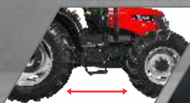
TRACTOR PESADO CON UNA DISTANCIA MÁS LARGA ENTRE EJES PARA UNA MEJOR ESTABILIDAD
